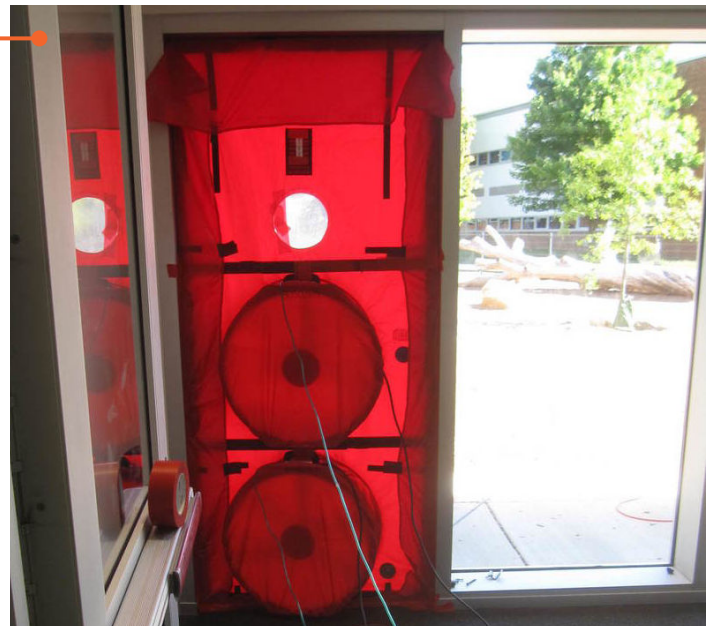
Blower door testing apparatus.
